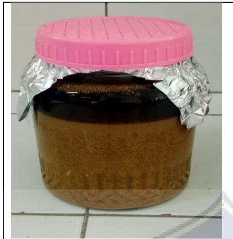
**Gambar 5.9** Proses maserasi menggunakan etanol 96%
