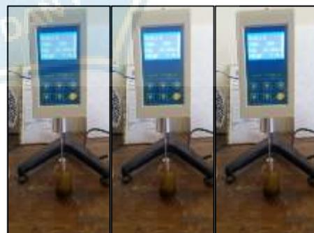
**Gambar 69.** Uji viskositas FIII hari ke-14
