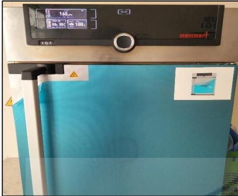
**Gambar 16.** Sterilisasi alat dengan suhu 160°C
