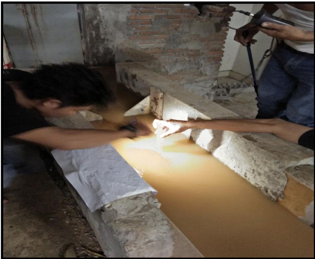
Pengukuran Kecepatan dan Tinggi Muka Air
