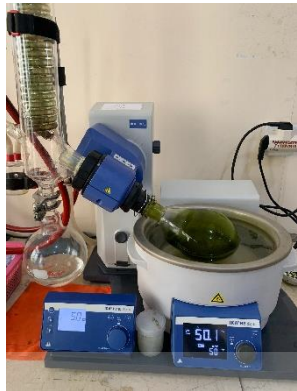
Gambar 7. Pembuatan ekstrak kental daun buni ( Antidesma bunius L.) menggunakan rotary evaporator
