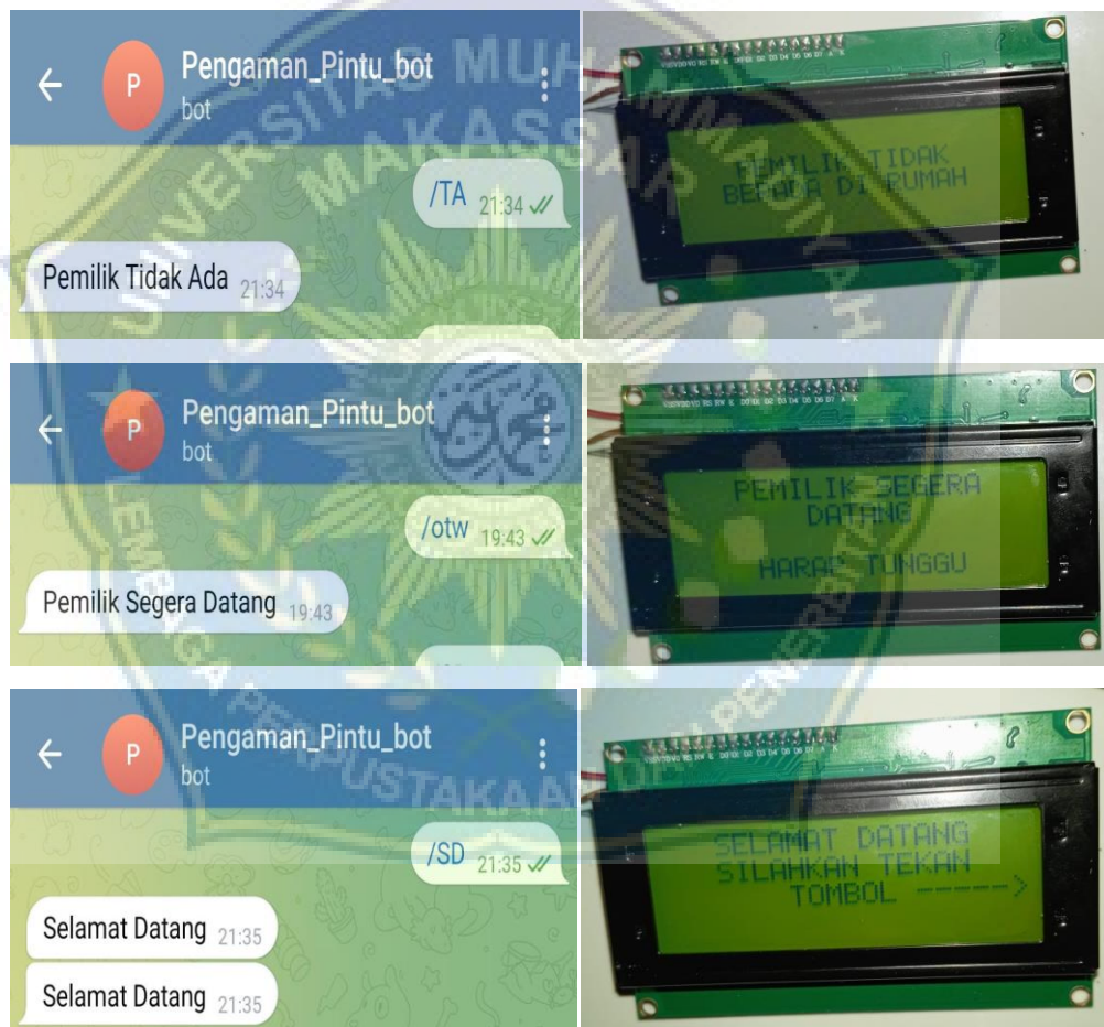
Gambar 4.6 Hasil Pengujian Telegram dan layar LCD
