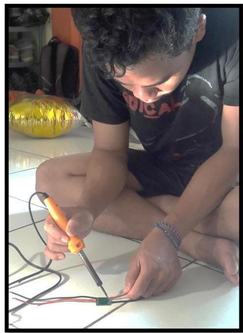
**Memasang Kabel Pada Step Up 5 V**
