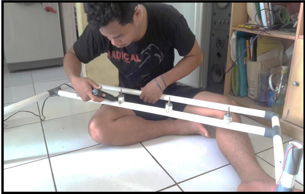
**Memberikan Lem Pada Generator Yang Dipasang Pada Pipa Rangka**
