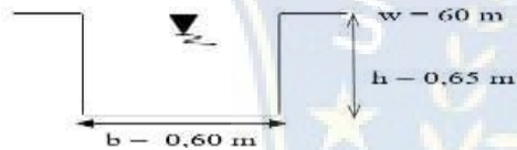
Gambar 35 Penampang saluran drainase tersier existing
