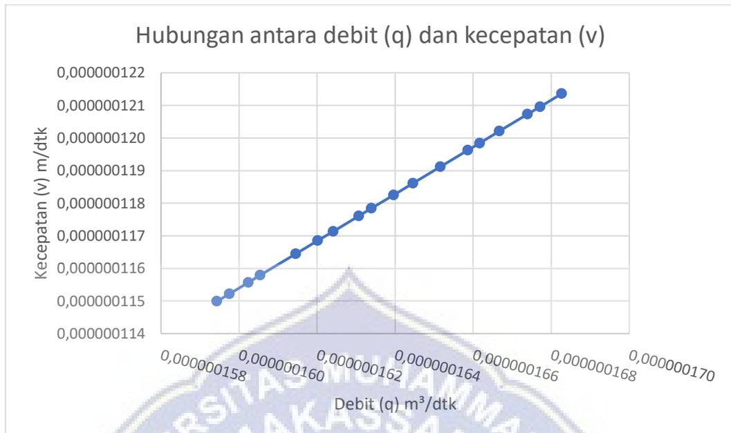
**Gambar 13.** grafik hubungan debit (q) dan kecepatan aliran (v) pada pipa 3/4 inci.
