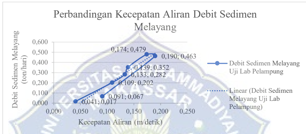
Grafik 8. Hasil Perbandingan Kecepatan Aliran dan Debit Sedimen Melayang Uji Laboratorium Pelampung Hulu.
