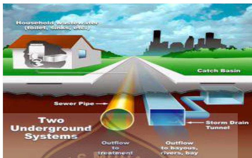
Gambar 2. 1 Sistem Penyaluran Air Limbah Terpisah Sumber: (Bayous, 2019)
