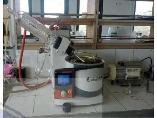
**Gambar 3. 14** Ekstraksi Kunyit Putih menggunakan Rotary Evaporator
