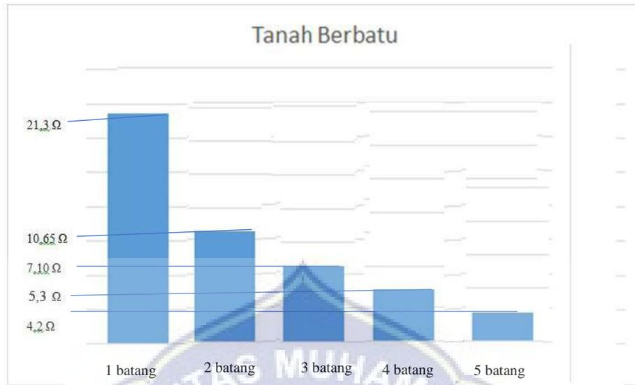
**Diagram Perbandingan Tahanan berdasarkan jumlah Elektroda pada Tanah Berbatu**
