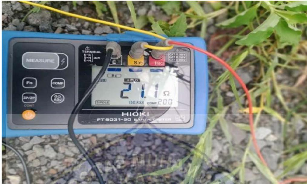
Gambar 4.5 Pengukuran Resistivitas Tanah di Jl. Rappocini Raya .
