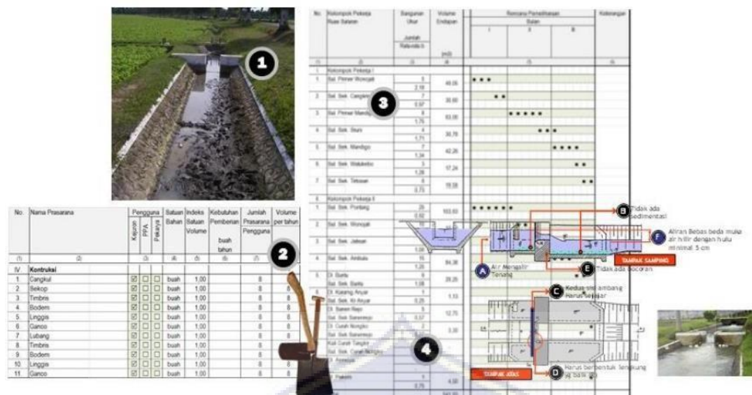
Gambar 12. Pemeliharaan Rutin – Pembuangan Endapan Lumpur di Bangunan Ukur Keterangan : (1) Endapan Lumpur pada Saluran ukur (midpan) bangunan ukur, (2) Peralatan pembuangan endapan lumpur di bangunan ukur, (3) Jadwal pembuangan endapan lumpur di bangunan ukur, (4) Hidrolis bangunan ukur
