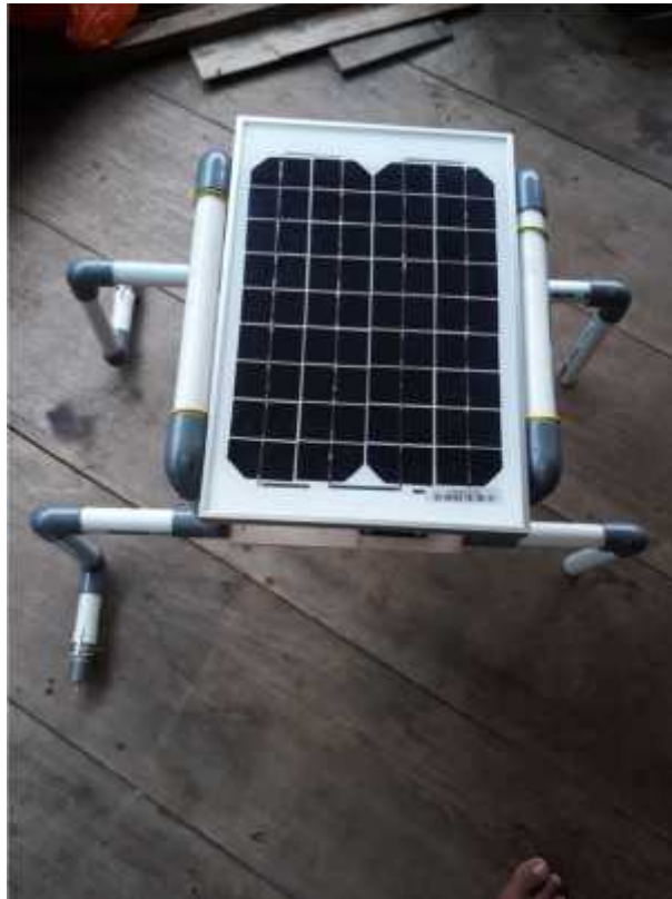
Gambar 4 Pengisian baterai mesin pemotong rumput
