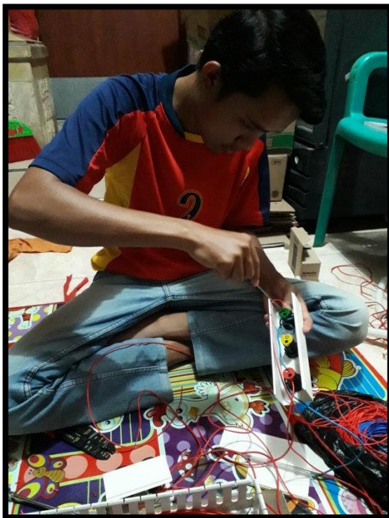
Memasang kabel pada lampu indikator
