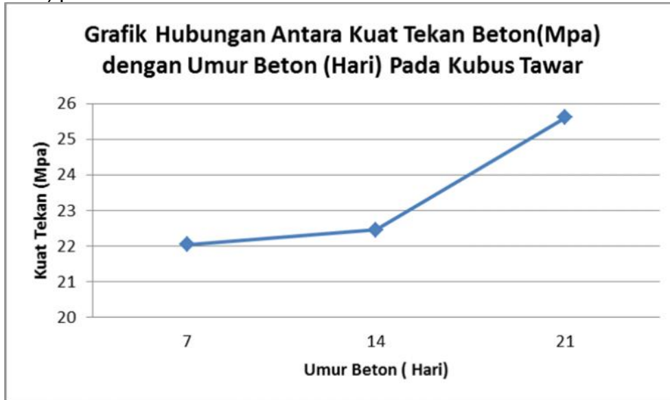
Grafik 3. Hubungan antara kuat tekan beton dan umur beton ( Hari) pada kubus tawar
