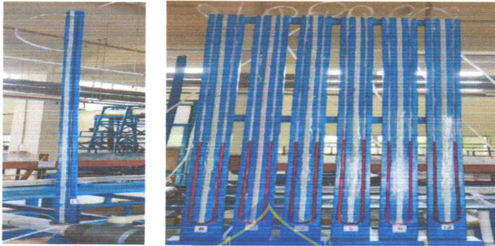
Gambar 10. Tabung Pitot dan manometer
