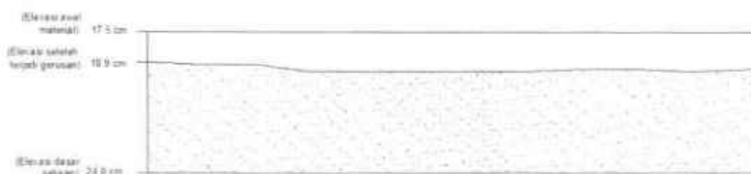
Gambar Penampang jarak melintang 28 cm dari pusat (hilir USBR) menggunakan Baffle Block 1:1
