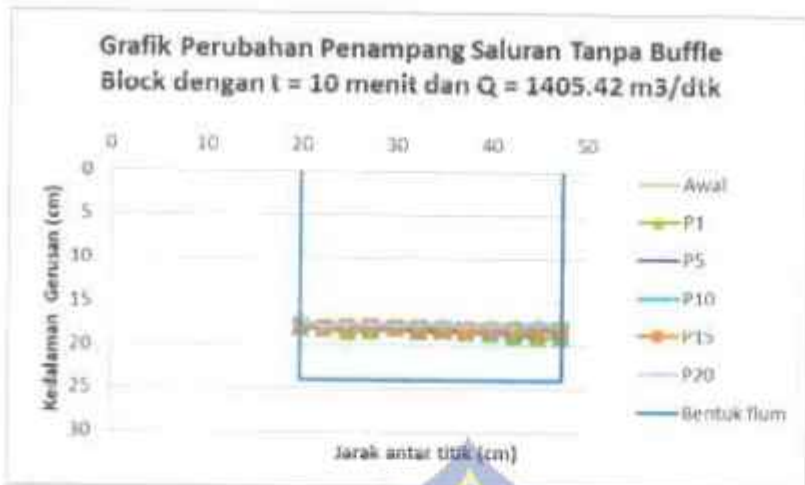
Grafik Perubahan Penampang Saluran Tanpa Menggunakan Buffle Block dengan H = 3,5 cm t = 10 menit dan Q = 1405.42 m 3 /dtk
