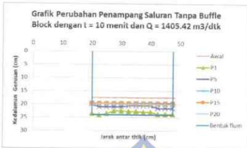
Grafik Perubahan Penampang Saluran Tanpa Menggunakan Baffle Block dengan H = 4 cm t = 10 menit dan Q = 1405.42 m 3 /dtk
