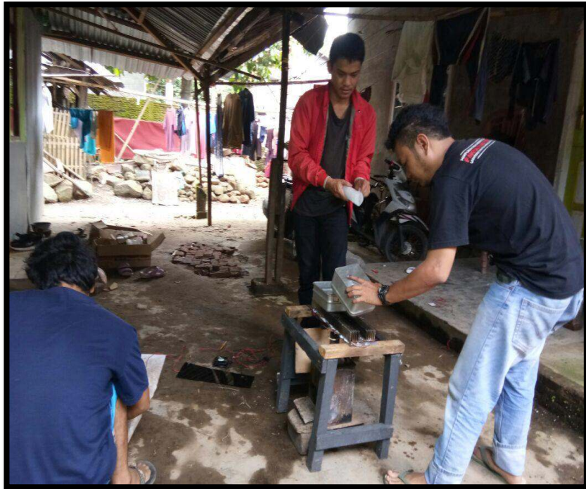
Penetapan es batu diatas heatsink, berfungsi untuk menetralkan panas yang diserap oleh heatsink
