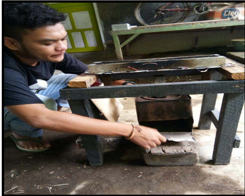
Gambar pemasangan tungku pembakaran pada rangkian pembangkit
