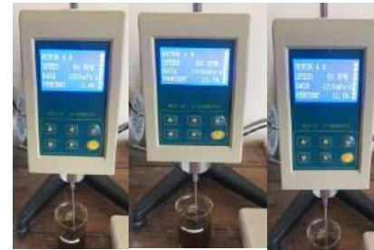
Gambar 53. Uji Viskositas FIII Setelah cycling
