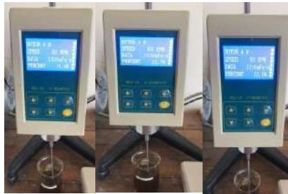
Gambar 52. Uji Viskositas FI Setelah cycling
