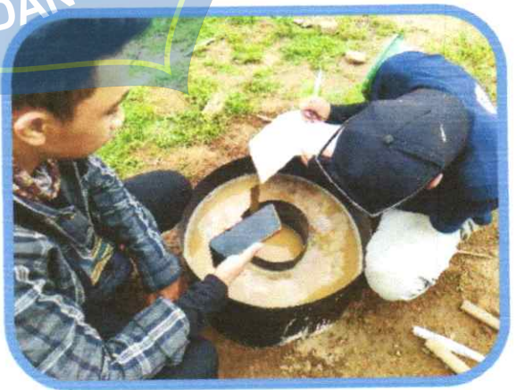
Pengukuran laju infiltrasi
