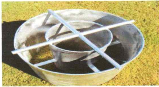
Gambar 4. double ring infiltrometer (Sumber : Reynold 1990)
