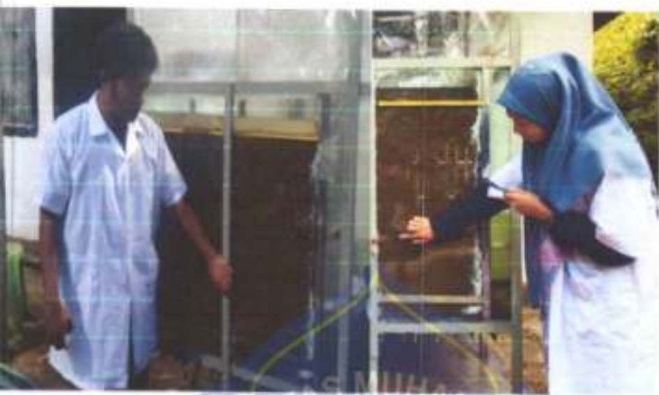
Pengukuran dihentikan jika air hujan dengan intensitas yang telah ditentukan telah habis dan ketinggian air tanah telah konstan.
