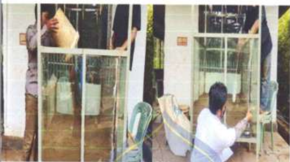
Proses pengisian bak simulasi dengan sampel tanah kemudian dipadatkan menggunakan bor pemadai mengelilingi tanah hingga kepadatan merata.
