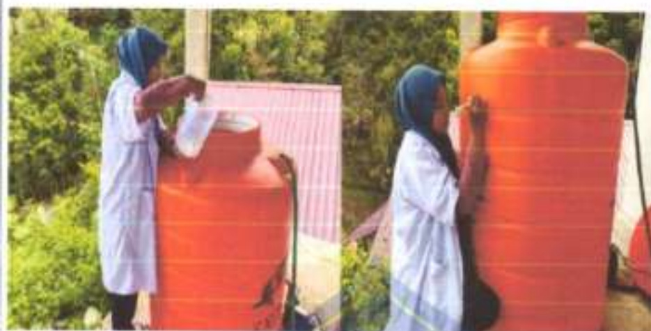
Proses pengisian air sesuai dengan intensitas curuh hujan kedalam tandon air kemudian diberi tanda tiap intensitas yang digunakan.
