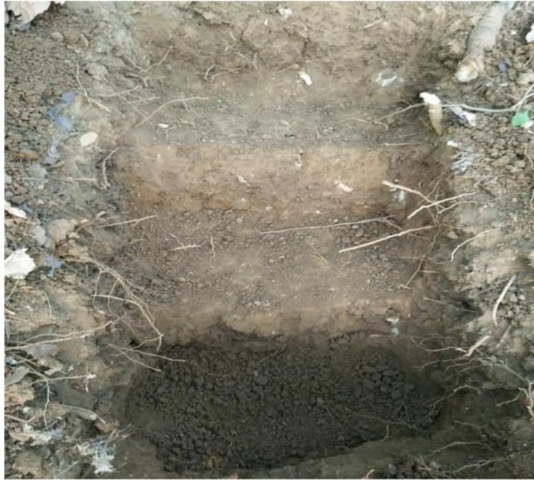
Gambar 6. Pedon Pengambilan Sampel Tanah
