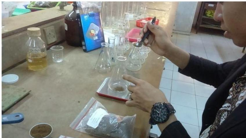
Gambar 9. Penimbangan Sampel Tanah
