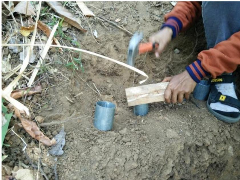
Gambar 7. Pengambilan Sampel Tanah
