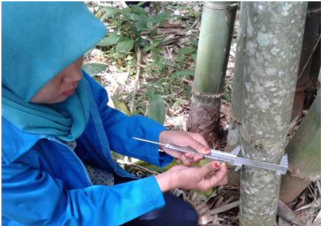
Gambar 8. Mengukur Diameter bambu menggunakan Calipper
