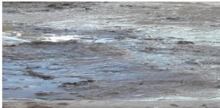
Gambar 4. Kotoran kuda, pasir dan tanah dicampur merata disiram sampai basah pada metode *scarifikasi* teknik konduksi thermal (lapis seng).
