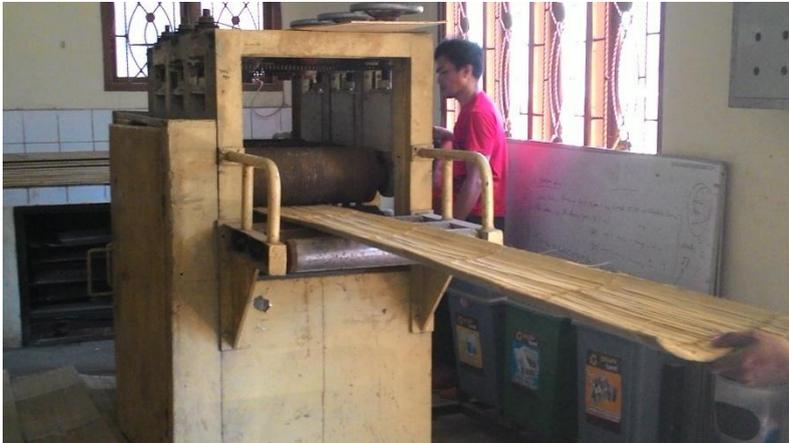
Gambar 13 Penghancuran struktur silinder bambu
