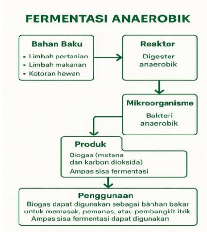
Gambar 2 Diagram Proses Fermentasi Anaerobik pada Biogas
