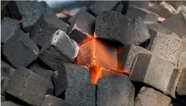
Gambar 5 Biobriket untuk Bahan Bakar
