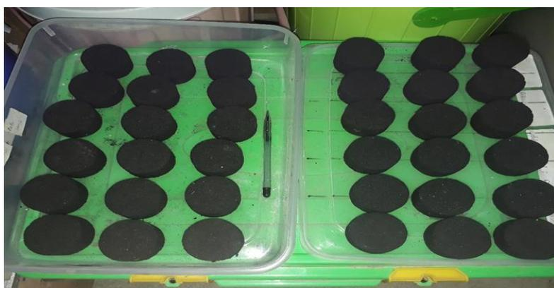
Gambar 10 Briket Arang Cangkang Kemiri yang Telah Dicetak
