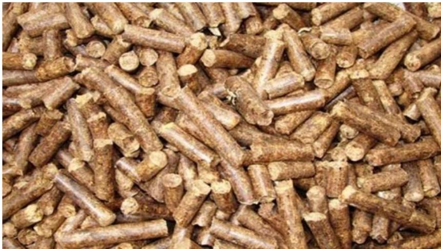
Gambar 12 Biopellet dari Limbah Kayu Berpotensi sebagai Energi Terbarukan Masa Depan
