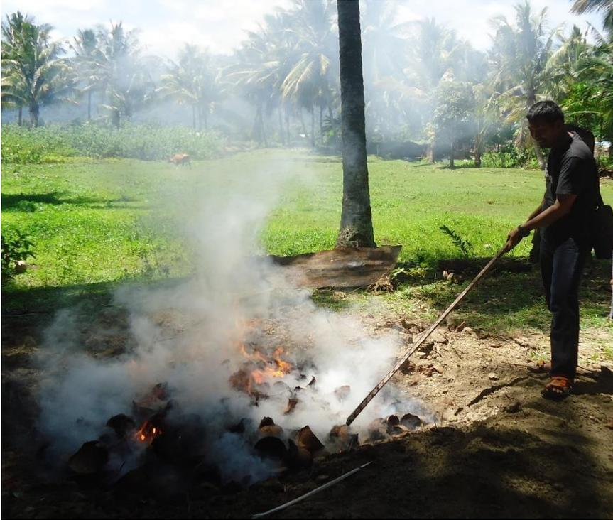
Gambar 5 Pembuatan Arang dari Tempurung Kelapa Secara Tradisional
