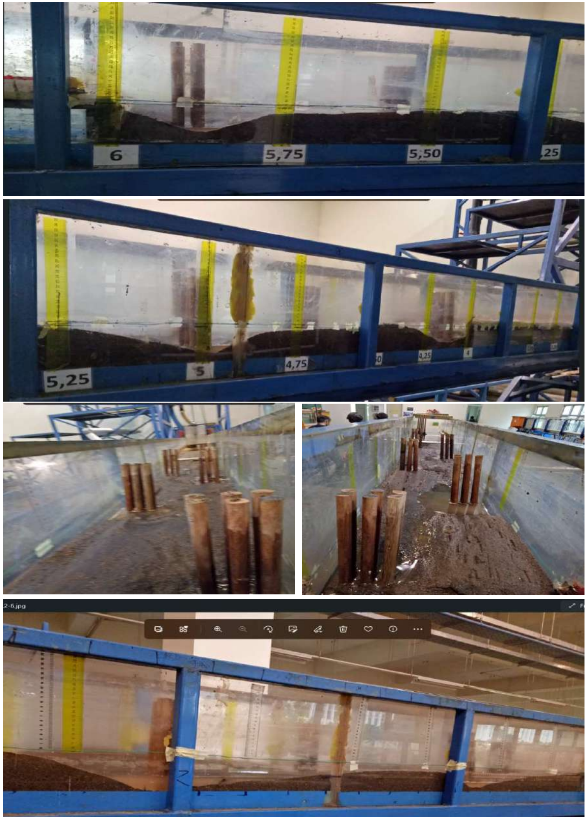
Gambar 34. Visualisasi hasil gerusan sedimen setelah ada krib Permeabel (DKDS) di sekitar krib permeabel.
