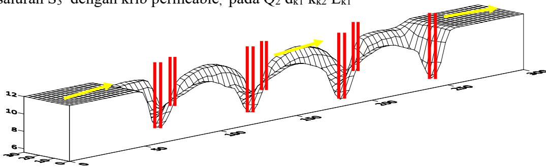
Gambar 111. Perubahan kountur pola gerusan dasar dengan kemiringan dasar saluran S_3 dengan krib permeable, pada Q_2 d_{k1} k_{k2} L_{k1}
