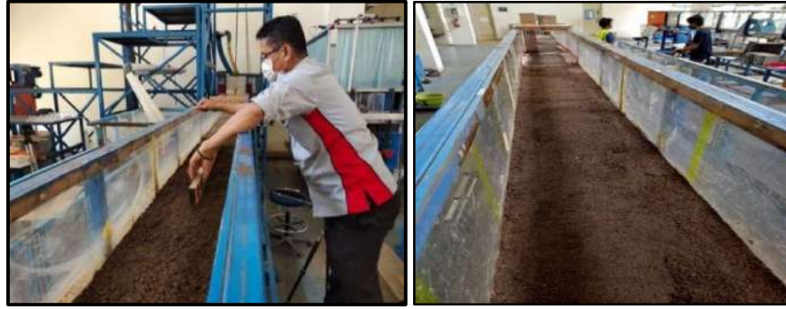
Gambar 23. Media uji tanpa krib dengan sedimen (TKDS)
