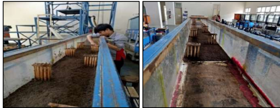
Gambar 24. Media uji dengan krib permeabel dengan sedimen (DKDS)
