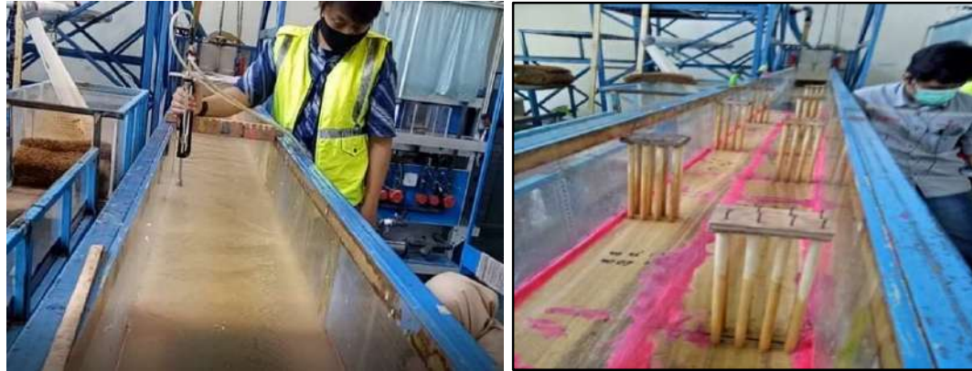
Gambar 26. Media uji dengan tanpa krib tanpa sedimen (DKTS) dan dengan krib tanpa sedimen (DSTS)
