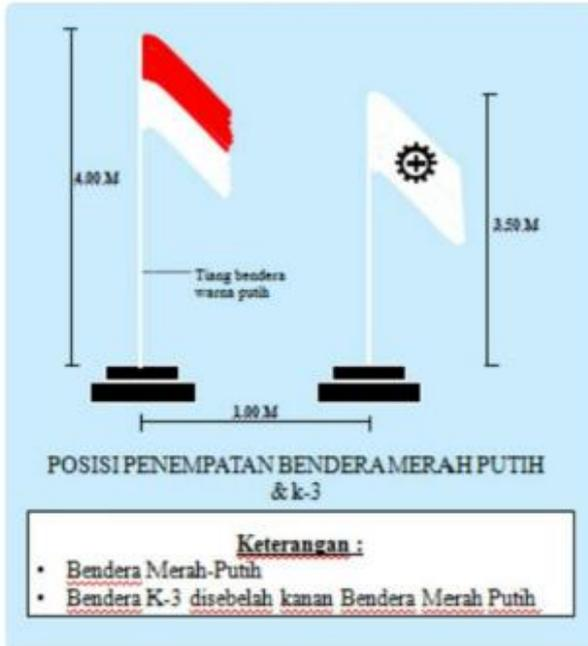
**Gambar 6. 3. Standar Penempatan Bendera K3**
