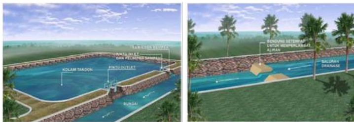
Gambar 9.9: Ilustrasi Kolam retensi untuk Drainase
