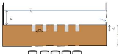
Gambar 10.6: Model Saluran Drainase Berpori Berwawasan Lingkungan
