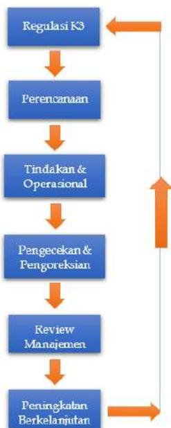
**Gambar 12.3:** Model Pendekatan Dasar Berdasarkan Standar OHSAS
