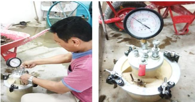
**Gambar 2.6.** Proses pengukuran kandungan udara beton
