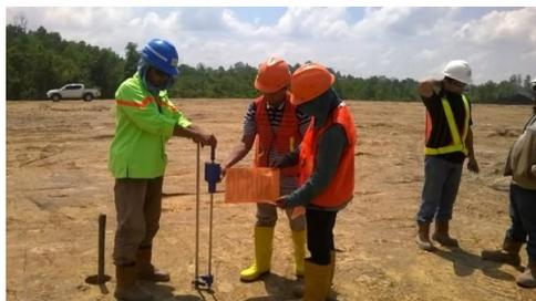
**Gambar 3.1.** Pengujian DCP
