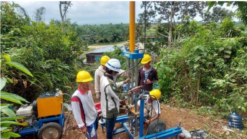
**Gambar 3.2.** Pengujian Sondir
