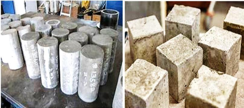
**Gambar 2.1.** Sampel selinder dan kubus beton
