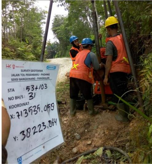
**Gambar 3.3.** Pengujian Bor Log
