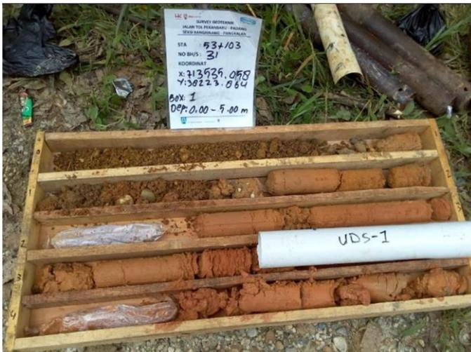
**Gambar 3.4.** Sampel tanah tak terganggu
