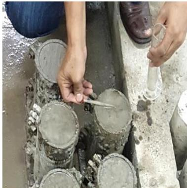
**Gambar 2.5.** Proses Pengukuran Kandungan Air Beton (*Bleeding*)
