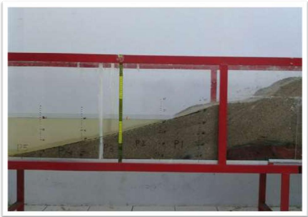
*Gambar 4. Pelindung pantai Pasir buatan*
