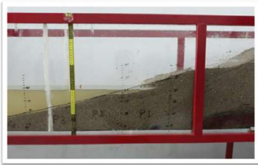
**Gambar 11.** Lapis lindung pasir buatan diberi gelombang selama 5 menit
