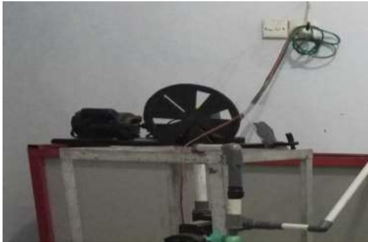
*Gambar 9. Alat pembangkit gelombang*
