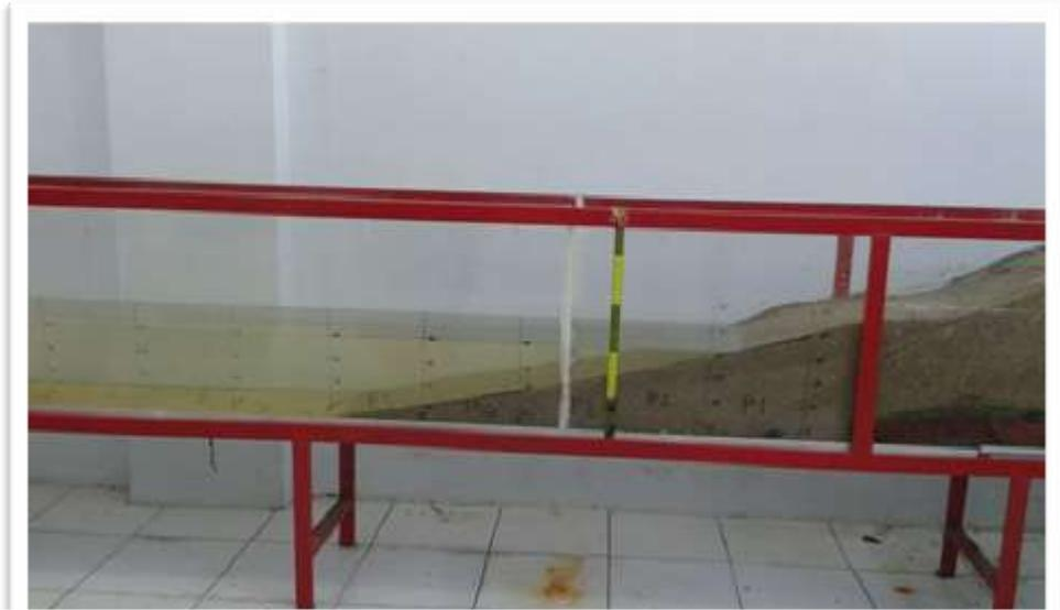
**Gambar 9.** Lapis lindung pasir buatan sebelum diberi gelombang
