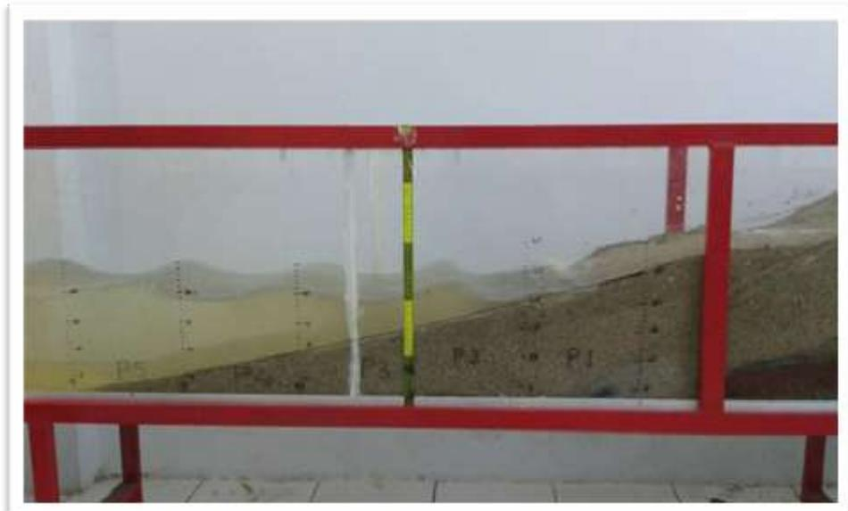
**Gambar 10.** Lapis lindung pasir buatan diberi gelombang selama 1 menit
