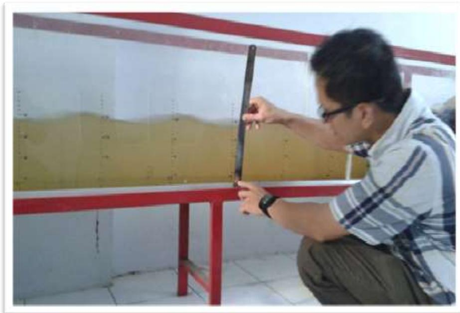
*Gambar 8. Pengukuran tinggi gelombang pada flume*
