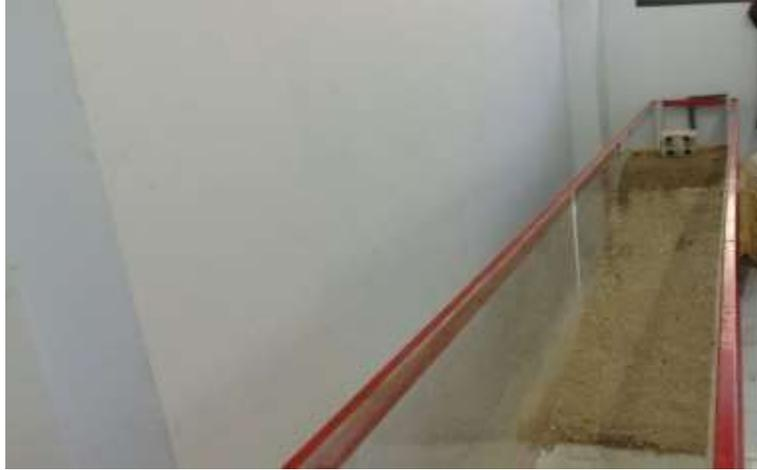
*Gambar 8. Tampak atas flume dan pasir buatan*
