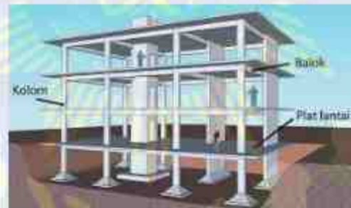
Gambar 21. Struktur Rangka Beton
