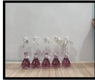
Gambar 8. 7 Pengenceran larutan stok sediaan gel dengan seri konsentrasi 20, 40, 60, 80, 100 ppm
