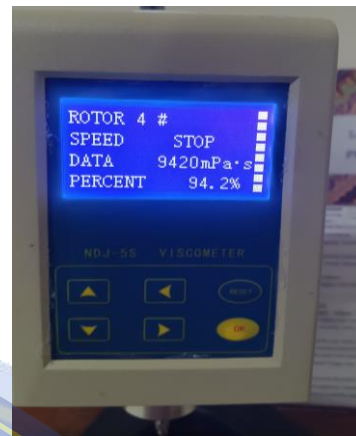
Gambar 11. 2 Uji Viskositas Sebelum Cycling test Formula 1
