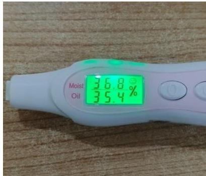
Gambar 13. 1 Pengukuran kelembaban sebelum cycling test F0 (lembab)
