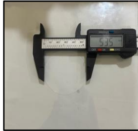
Gambar 10. 1 Uji Daya Sebar Sebelum Cycling test Formula 0
