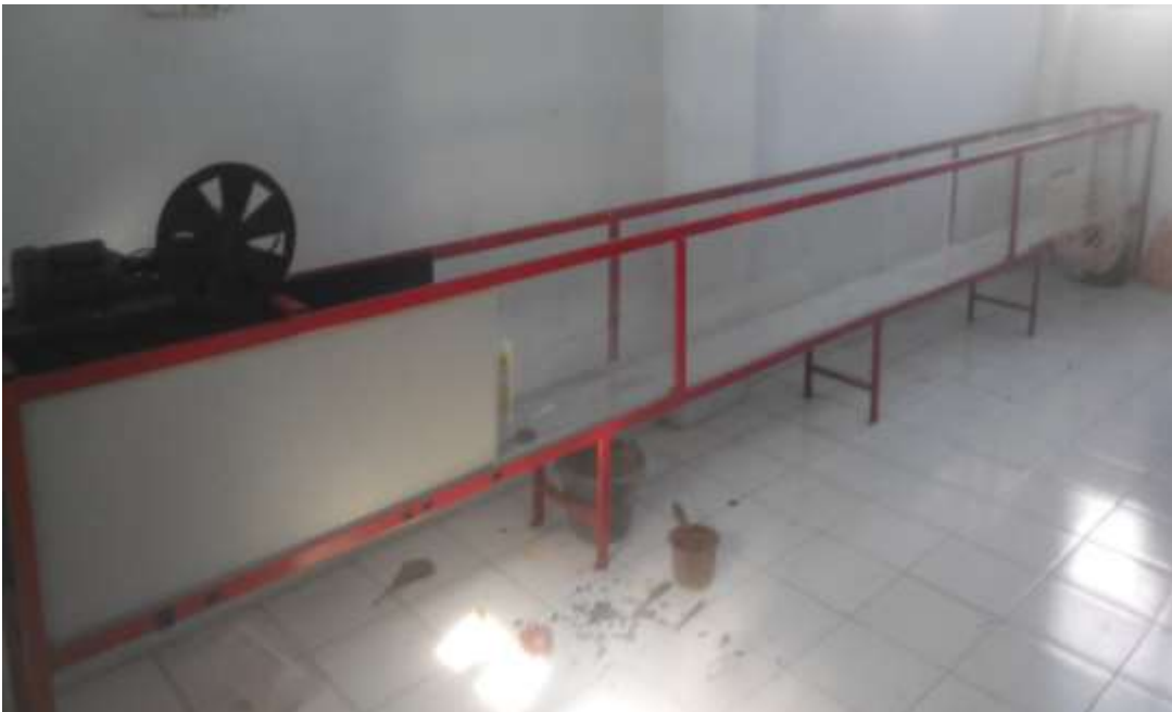
Gambar 10. Tangki Pembangkit Gelombang ( Wave Flume )
