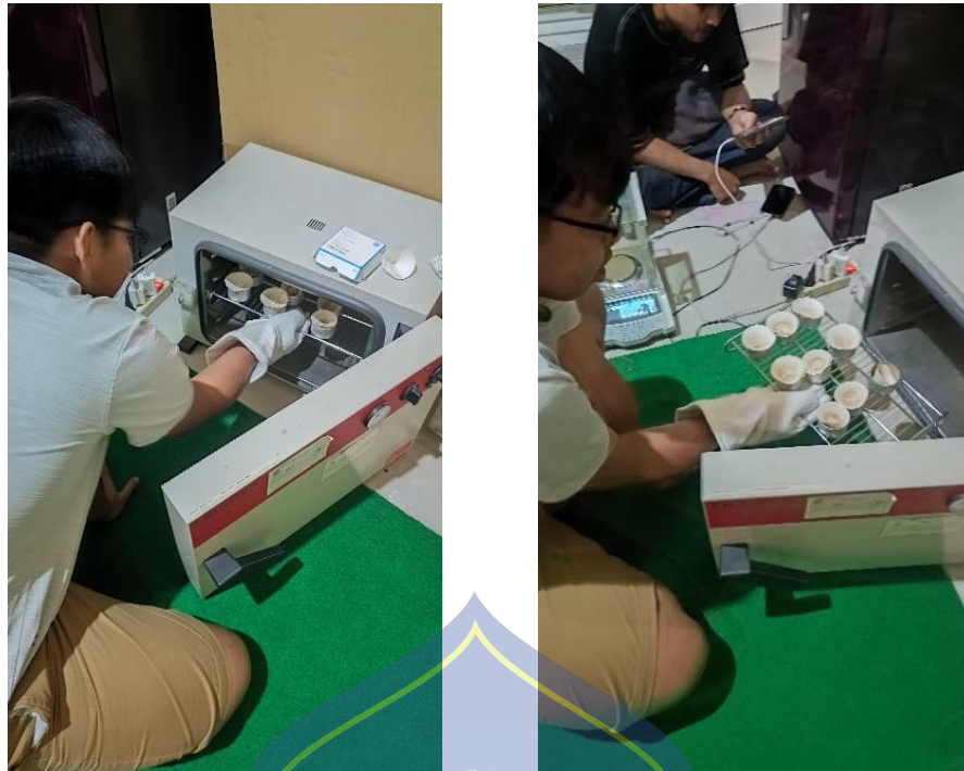
Gambar 12. Proses Pengovenan Sedimen
