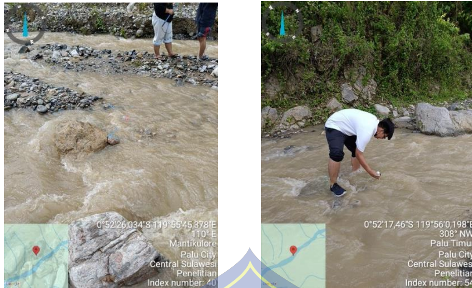
Gambar 7. Pengambilan Sampel Sedimen
