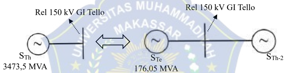
Gambar 4.2.2.1. Diagram Ekstraksi Kapasitas Hubung-Singkat #GE1 (Tahap Kedua)
