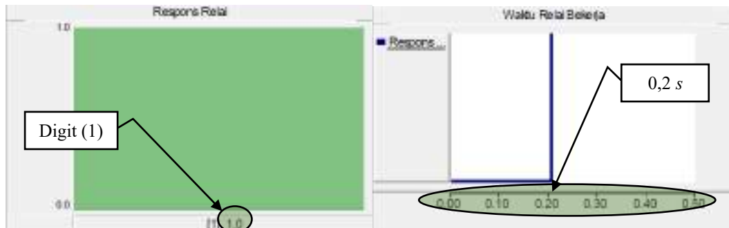
Lampiran A.8a. Display Numeris dan Grafis pada Kondisi Gangguan Internal di titik 60%
