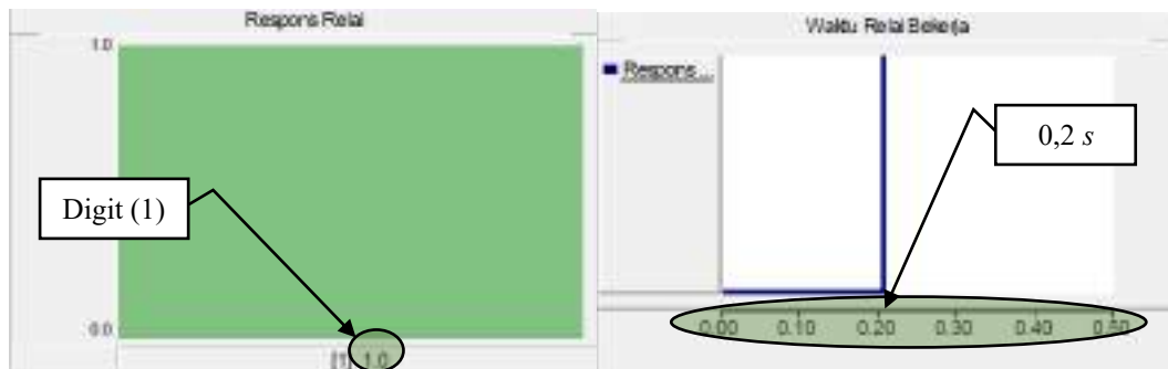
Lampiran A.10a. Display Numeris dan Grafis pada Kondisi Gangguan Internal di titik 70%
