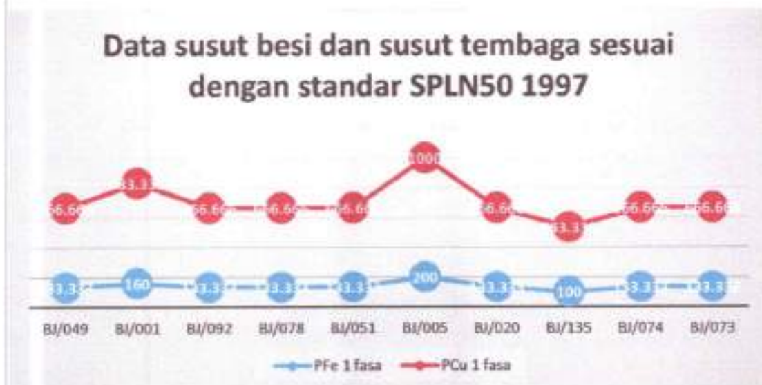
Gambar 4.1. Data susut besi dan susut tembaga sesuai dengan standar SPLN50 1997
