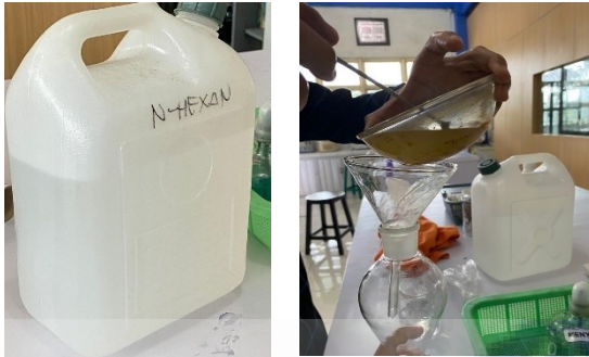
Fraksinasi (menggunakan pelarut n-heksan)
