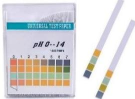
Kertas lakmus digunakan untuk menguji keasaman atau kebasaan suatu larutan. Alat ini memungkinkan siswa mengamati perubahan warna sebagai indikator pH, yang memperkenalkan mereka pada konsep asam, basa, dan indikator kimia. Eksperimen ini memperkenalkan siswa pada pengujian kimia yang sederhana namun ilmiah, membantu mereka memahami bahwa zat kimia memiliki sifat yang berbeda.
