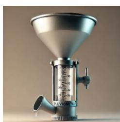
Pluviometer digunakan untuk mengukur jumlah hujan dalam suatu periode tertentu. Ini memberi siswa kesempatan untuk mengamati pola cuaca secara langsung dan mencatat perubahan curah hujan. Alat ini memperkenalkan siswa pada konsep pengukuran iklim dan cuaca, serta pentingnya air sebagai sumber daya alam.
