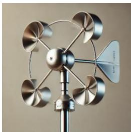
Anemometer digunakan untuk mengukur kecepatan angin. Alat ini memperkenalkan siswa pada pengaruh kecepatan angin dalam kehidupan sehari-hari, seperti dalam mempelajari fenomena angin kencang, angin topan, atau pola cuaca. Eksperimen dengan anemometer memberikan siswa wawasan tentang pola cuaca dan dinamika atmosfer, serta meningkatkan kesadaran mereka terhadap cuaca dan pengaruhnya terhadap kehidupan manusia.
