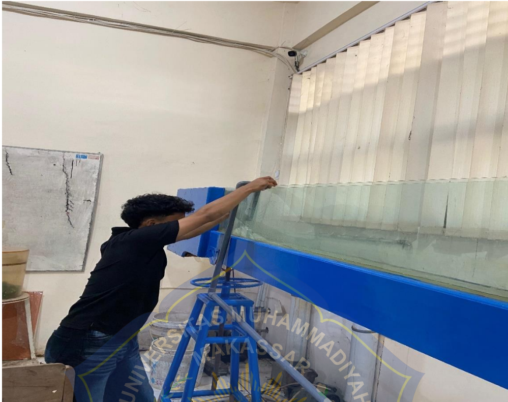
Gambar 3 Menjatuhkan bola pimpong untuk mengetahui kecepatan aliran
