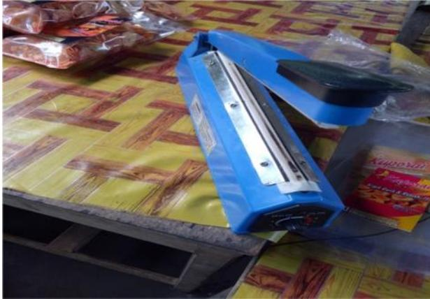
Gambar 10: Alat pres atau alat yang digunakan untuk merekatkan pembungkus keripik pisang agar dapat bertahan lama.
