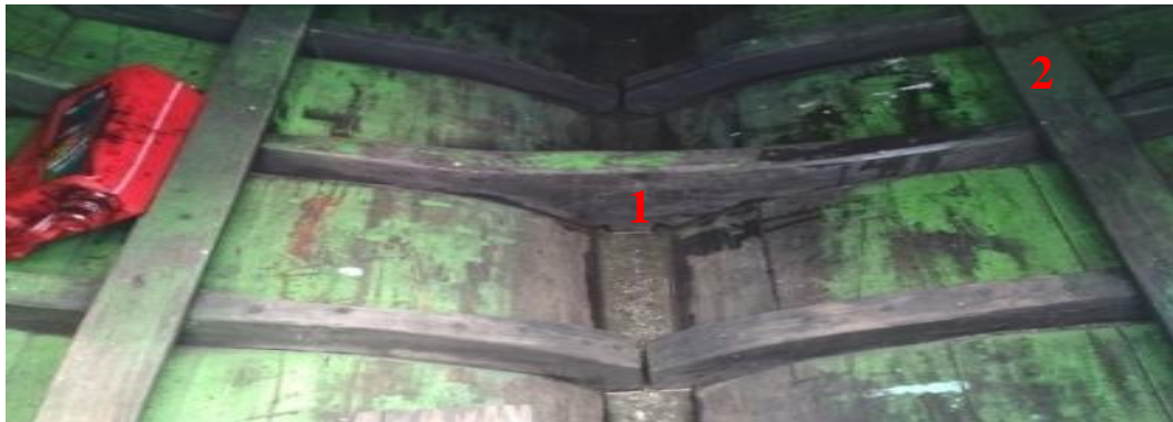
Gambar 2. Gading dan Lepe Perahu Bego
