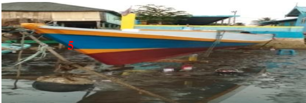
Gambar 5. Linggi Haluan Perahu Bego
