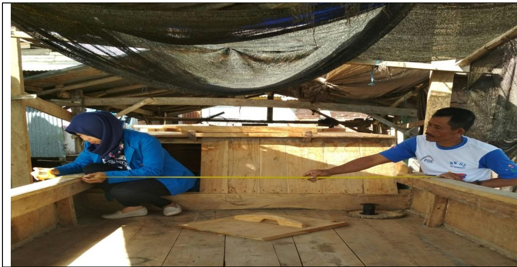
3. Mengukur lebar total perahu Bego
