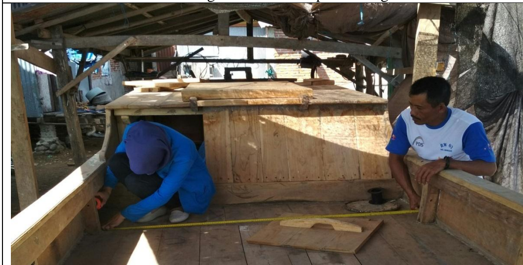
4. Mengukur lebar dalam perahu BGO
