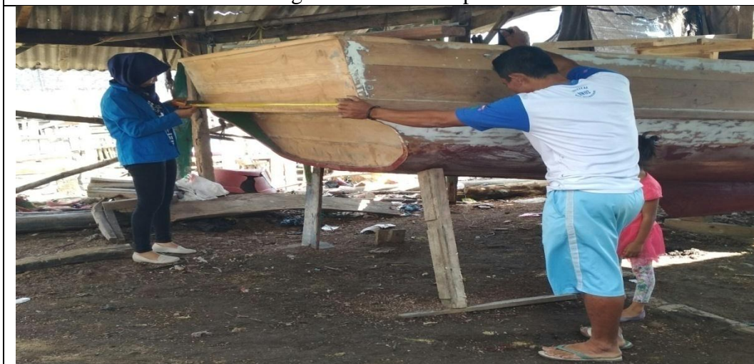
5. Mengukur lebar buritan perahu Bego
