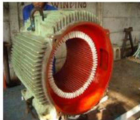
Gambar 2.6 Bentuk konstruksi stator pada generator sinkron
