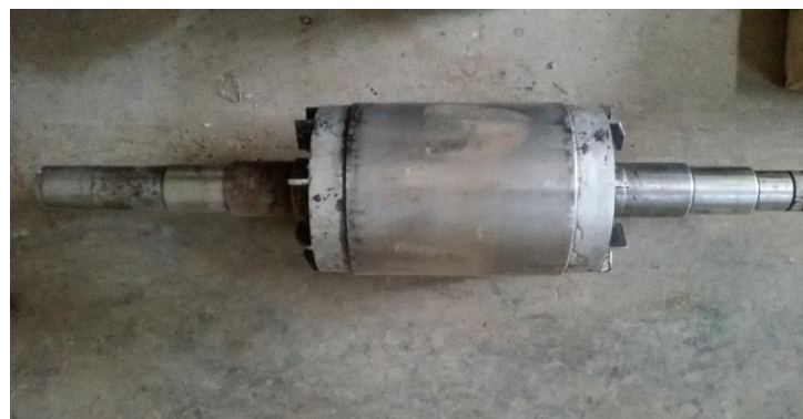
Gambar 3.6 Rotor saat akan digabung dengan stator
