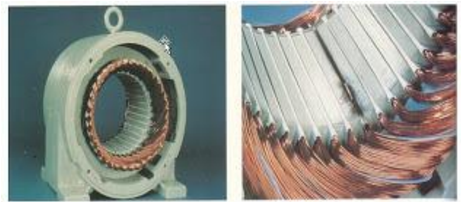
Gambar 2.13 Konstruksi stator dengan alur-alurnya
