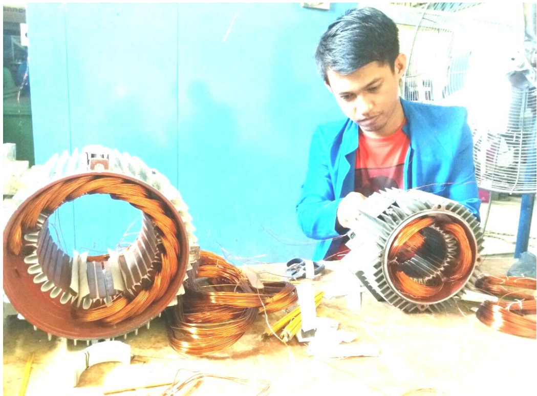
Proses pemasangan Kawat Email/Kumparan Pada Stator
