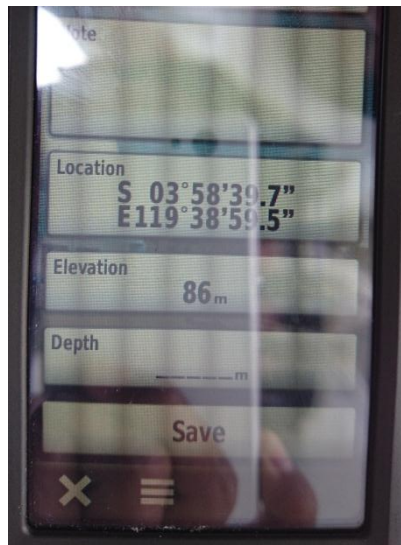
Gambar 4.1 Hasil pengukuran posisi geografis antena
