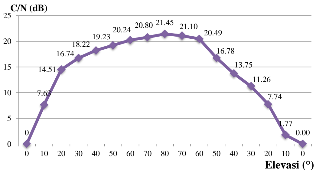
Gambar 4.19 Grafik Hasil Pengukuran Nilai Carrier to Noise ratio Antena Stasiun Bumi terhadap Sudut Elevasi Antena
